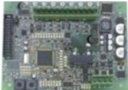
Die 8er-Analogeingangsmodule STG/IN8-S dienen dem Anschluss von bis zu 8 Messwertgebern mit 4-20mA-Ausgang.
